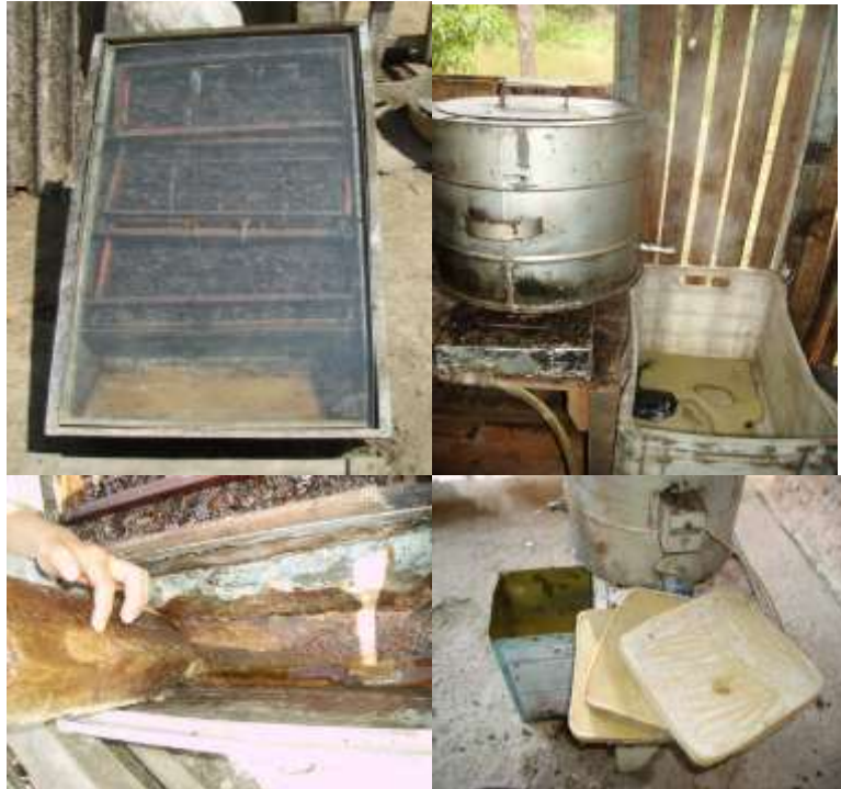
Figura 5.4: Cocho derretedor solar com ferrugem, Apicultor C. Fonte: Soares, E.T.
