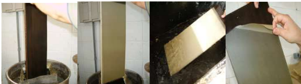
Figura 5.7: Sequência Técnica : mergulhando a tábua no tanque; escorrendo o excesso de cera; resfriando a lâmina; retirando a lâmina. (da esquerda para a direita) Fonte: Soares, E.T.
