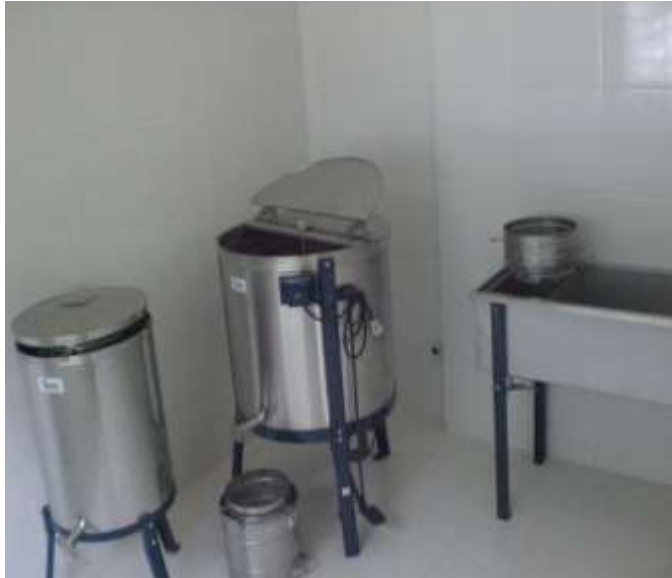
Figura 2.7: Da direita para esquerda: Mesa desoperculadora, centrífuga radial, peneira, decantador Fonte: Acervo da autora
