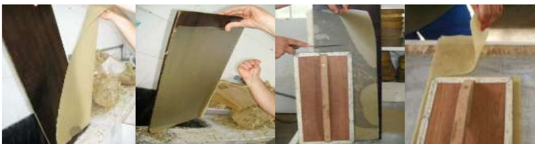
Figura 5.8: Sequência Técnica: retirando a lâmina; retirando as arestas; detalhe da posição da lâmina na tábua; retirando a parte superior da lâmina, mais delgada. (da esquerda para a direita)
