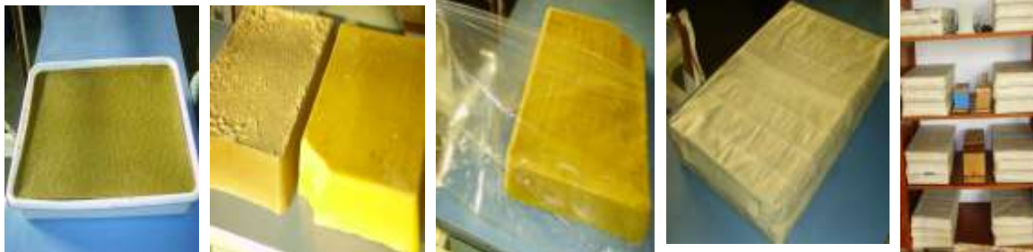
Figura 5.12: Da esquerda para a direita, cera resfriando em bandeja plástica, facilidade para desenformar; bloco de cera com resíduos da extração e um com resíduos já raspados; bloco sendo envolto por plástico filme PVC; depois de envolto em filme PVC finaliza com uma camada de jornal; estoque devidamente embalados.
