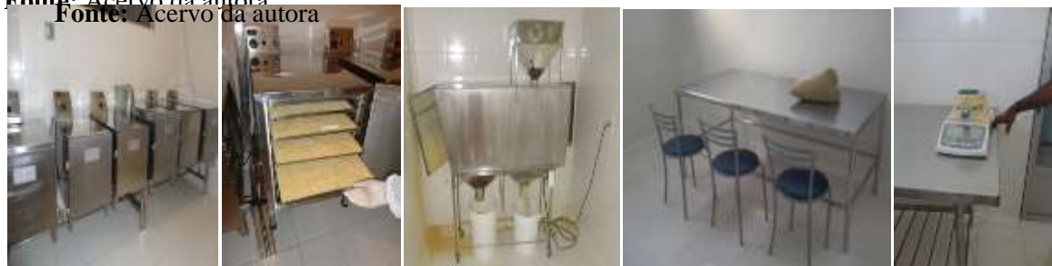
Figura 3.15: Estufas Desidratação 40°C; Distribuição em bandejas ; Aeração do produto desidratado; Catação de sujidades; Balança verificadora de umidade.
