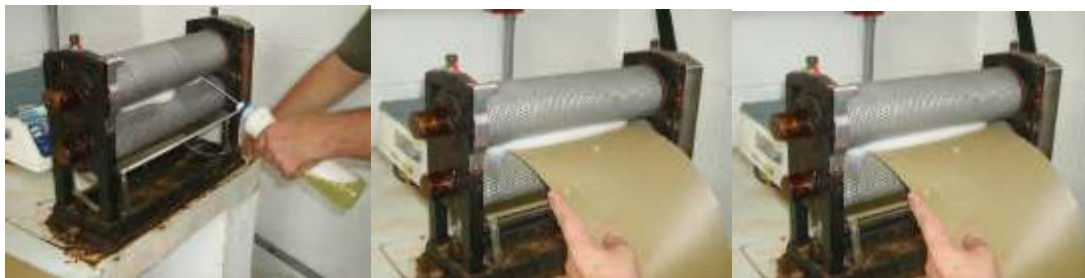
Figura 5.9: Sequência Técnica: lubrificando o cilindro com água e detergente; laminado; a lâmina grudada, cera quente. (da esquerda para a direita).
