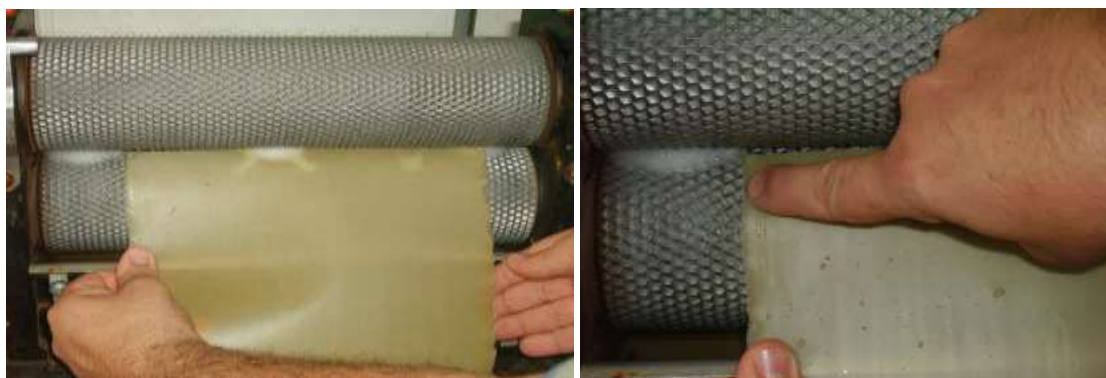
Figura 5.10: Sequência Técnica: lâmina alinhada em 90° com o cilindro; detalhe do alinhamento dos alvéolos.
